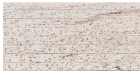
Vlekvorming/schimmel op het oppervlak
